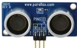
超音波を発射して障害物に反射して帰る時間を測定することで距離を計算できるセンサーです。
